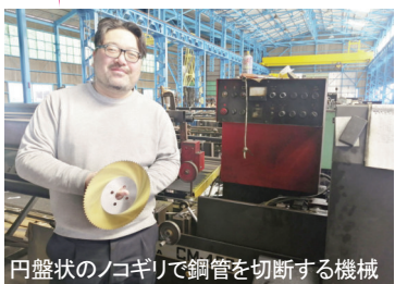
円盤状のノコギリで鋼管を切断する機械
